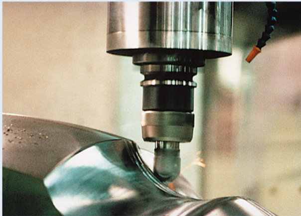
금형 Ball endmilling, 30~35 HRc. 25~30배의 공구 수명 증가 및 후가공 시간의 대폭 단축 Milling of die molds, 30~35 HRc 25~30 times longer tool life, significant reduction of hand finishing
