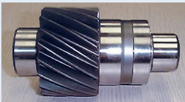
Side Shaft (HRc 58~62, 25Cr Mo4)의 외경 및 단면가공 절삭속도 138~145m/min로 타사대비 30% 수명 향상 O.D. face turning of side shaft / HRc 58-62, 25CrMo4 Turning speed 138-145m/min, 30% tool life increase over competitor
